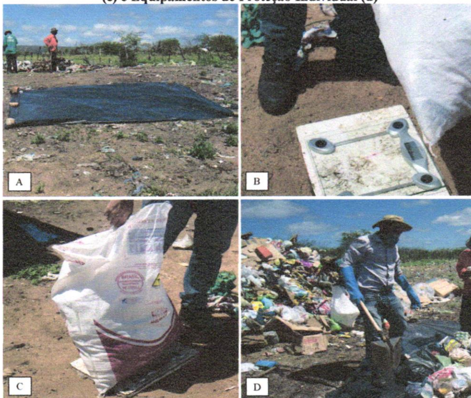
Figura 7.1 – Materiais usados no processo de gravimetria: Lona (a), Balança (b), Sacos plásticos (c) e Equipamentos de Proteção Individual (d)
